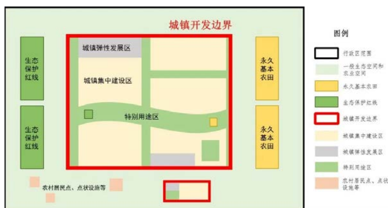
图1 三条控制线与用途分区示意图
